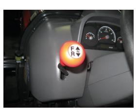
**Boite de vitesse mécanique** Levier d'inverseur mécanique synchronisé. Disponible pour les versions 45 à 55 ch.
